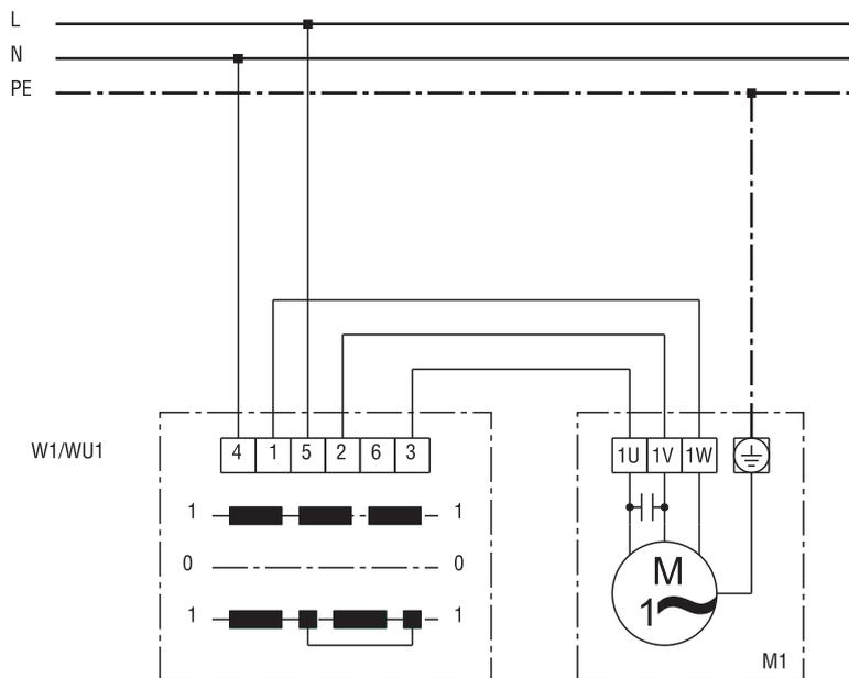
W1 / WU1 - Wendeschalter: Entlüftung / Aus / Belüftung
