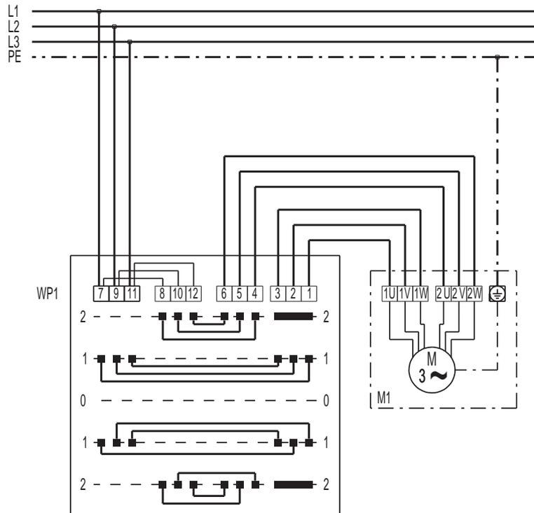
WP1 Wendepolumschalter: Stufe2/Stufe1/Aus/Stufe1/Stufe2
