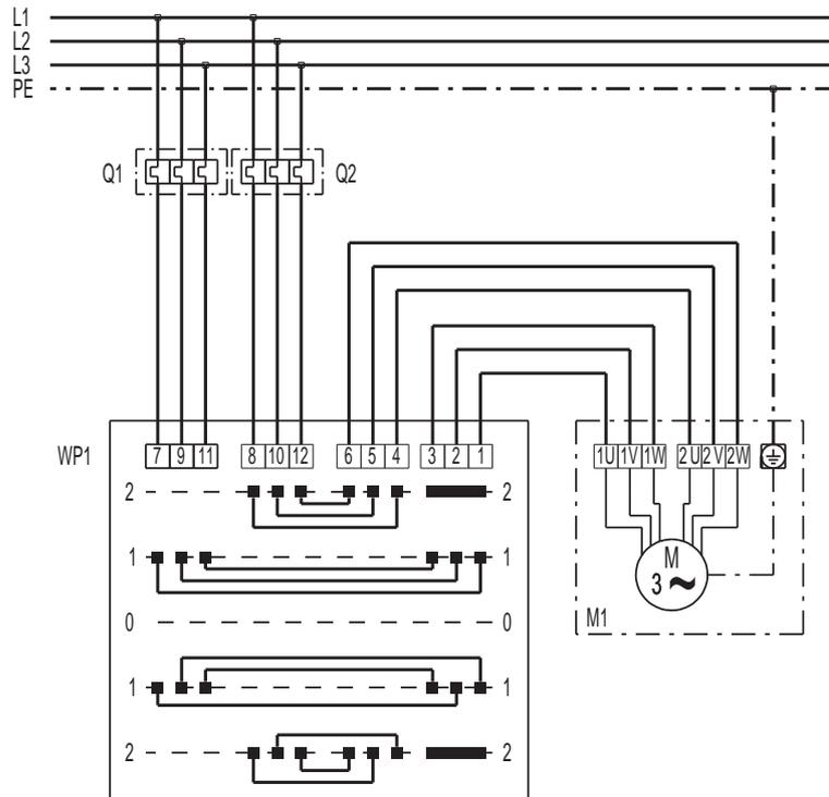
WP1: Wendepolumschalter Stufe 2/Stufe 1/Aus/Stufe 1/Stufe 2
