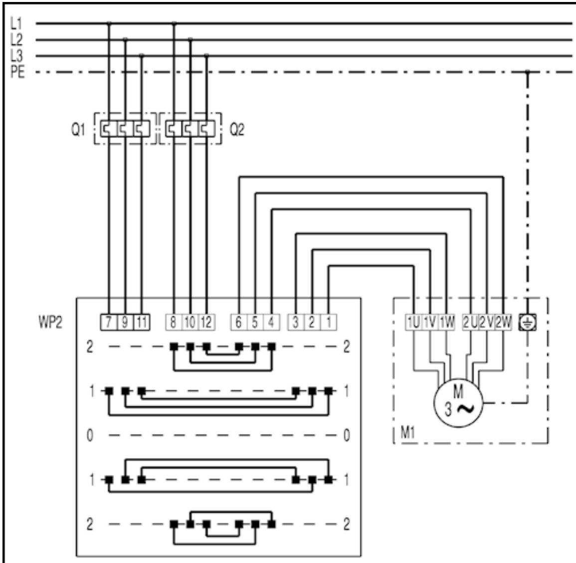
WP2: Wendepolumschalter Stufe 2/Stufe 1/Aus/Stufe 1/Stufe 2
