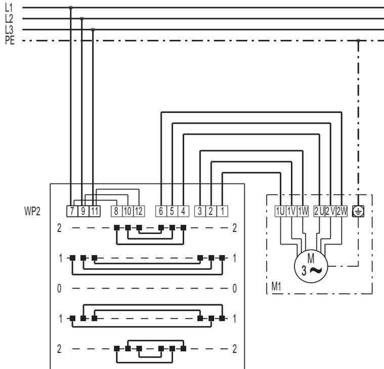
WP2 Wendepolumschalter: Stufe2/Stufe1/Aus/Stufe1/Stufe2
