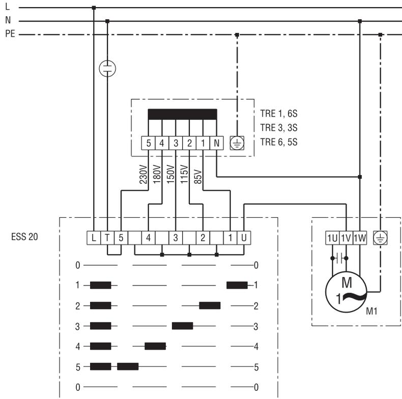
TRE..S-2 - 5-Stufentransformator
