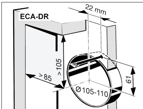
1. Réaliser un perçage de cloison.
