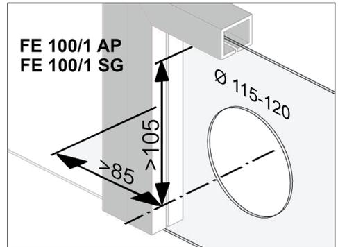
1. Scheibenausschnitt vom Fachmann anbringen lassen. Bei Wand-/Holzplattenmontage einen Ausschnitt bohren.
