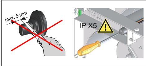
**ACHTUNG IP-Schutz** nur gewährleistet, wenn die Leitungsstülpe des ECA 100 ipro ordnungsgemäß durchstochen wird. Leitungsstülpe nicht wie in der ECA 100 ipro-Montageanleitung beschrieben abschneiden.
