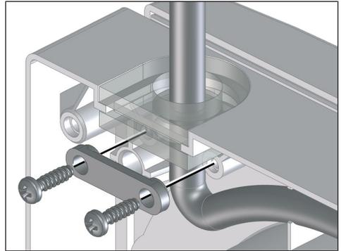
5. Netzleitung mit der Zugentlastung befestigen und im Distanzrahmen nach rechts verlegen.
