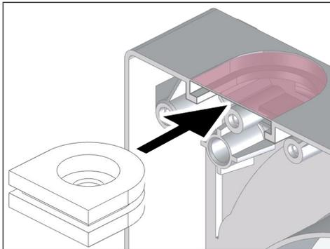
3. An einem Distanzrahmen den im Gehäuse vorgesehenen Durchbruch ausschneiden und die Leitungstülle einschieben.
