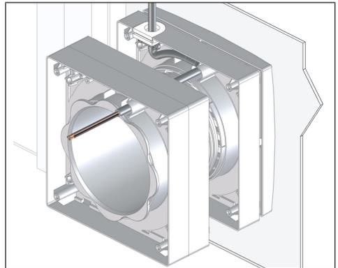
6. Die Netzleitung durch die 10,5 mm-Bohrung der anderen Distanzrahmen schieben.
