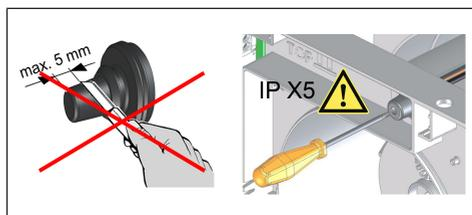
**⚠ DANGER** en raison de court-circuit/incendie suite à pénétration d'humidité dans l'espace de branchement. En cas de pose incorrecte du câble impossibilité de monter le cache électronique à plat et de manière étanche. Respecter la longueur de câble autorisée dans l'espace de branchement. Le manchon doit être fixé fermement et de manière étanche dans le boîtier, également avec le câble secteur.
