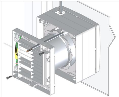
12. Ventilator mit 2 Schrauben an den Distanzrahmen schrauben.
