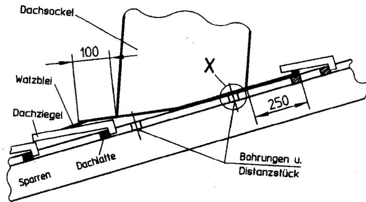
Dachsocket an den vorgestanzten Bohrlöchern am Sparren oder an der Auswechselunterkonstruktion befestigen. Es muss eine sichere und dauerhafte Befestigung des Dachsockets gewährleistet sein. Aufbaugewichte und Gebäudestatik beachten. Windlast!
