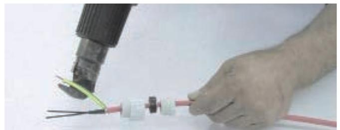
6. Föhnen Sie den Erdungsschrumpfschlauch mittels Heißluftföhn auf.
