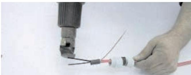
5. Föhnen Sie den Schrumpfschlauch 9/3 20 mm mittels Heißluftföhn auf.
