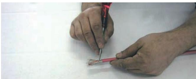
2. Trennen Sie das Schutzgeflecht bzw. den Aluschirm auf. Drehen Sie das Schutzgeflecht zusammen und biegen Sie es zurück bzw. entfernen Sie den Aluschirm und biegen die Erdung zurück.
