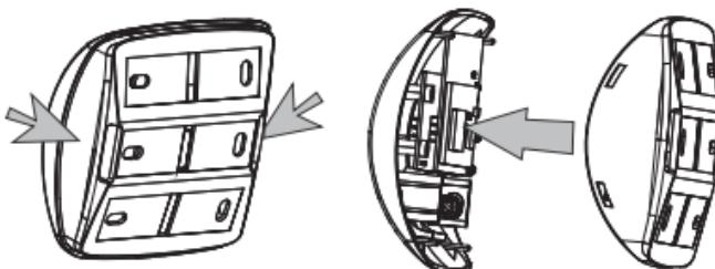
Coloque la pila en el sentido correcto (polo "+" en el lado "+" y polo "-" en el lado "-").
