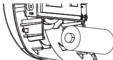
Po włożeniu baterii, można dodać połączenie wewnętrznego czujnika ruchu w centrali TaHoma.
