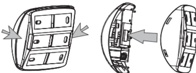
Vložte baterii správným směrem (pól „+“ ze strany „+“ a pól „-“ ze strany „-“).
