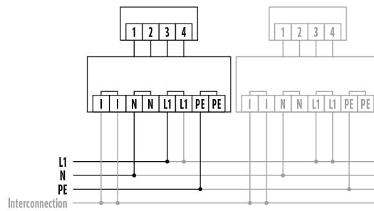
Standardbetrieb. Optional: Vernetzung mit max. 30 Meldern (max. Leitungslänge 300 m). Filter gegen netzgebundene Störungen am PROTECTOR K 230 V.
