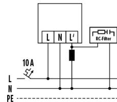
Bei Schaltung von Induktivitäten (z. B. Relais, Schütze, Vorschaltgeräte) kann der Einsatz eines RC-Filters (A) erforderlich sein.
