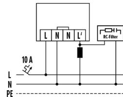
Bei Schaltung von Induktivitäten (z. B. Relais, Schütze, Vorschaltgeräte) kann der Einsatz eines Löschlides (A) erforderlich sein.
