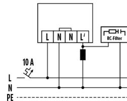
Bei Schaltung von Induktivitäten (z. B. Relais, Schütze, Vorschaltgeräte) kann der Einsatz eines Löschgliedes (A) erforderlich sein.
