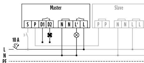
Standardbetrieb mit optionaler Ansteuerung durch Schließaster und Verwendung von max. 10 Slave-Geräten an einem Master-Gerät.
