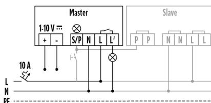
Standardbetrieb mit optionaler Ansteuerung durch SchlieBtaster und Verwendung von max. 10 Slave-Geräten an einem Master-Gerät.
