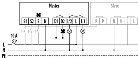
Standardbetrieb mit optionaler Ansteuerung durch Schließtaster und Verwendung von max. 10 Slave-Geräten an einem Master-Gerät.
