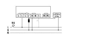
$Standard betrieb\ mit\ optionaler\ Ansteuerung\ durch\ Schließtaster\ und\ Parallels chaltung\ von\ max.\ 10\ Ger\"{a}ten$
