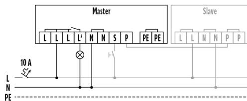
Standardbetrieb mit optionaler Ansteuerung durch Schließaster und Verwendung von max. 10 Slave-Geräten an einem Master-Gerät.
