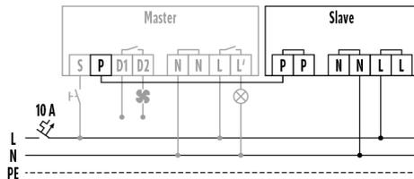
Master-Slave-Schaltung für Präsenzmelder: Es können max. 6 Slave-Geräte an ein Master-Gerät angeschlossen werden.
