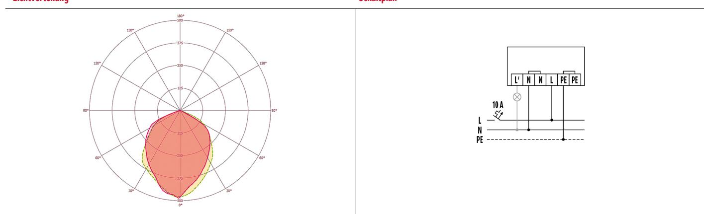
Standardbetrieb mit optionalem Anschluss von externen Lasten
