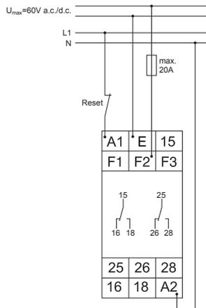
Messbereich 300V, Versorgung 24V a.c./d.c. und Fehlerspeicher
