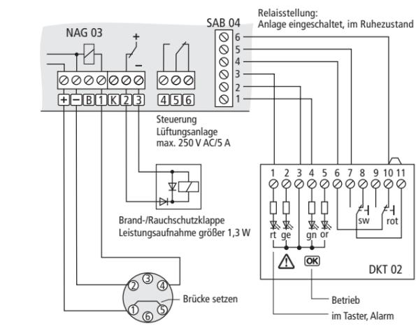
**Hinweis:** Bei Verwendung des SAB 04 mit einem DKT 02 muss der Jumper auf dem SAB 04 abgezogen werden!
