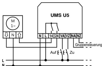
**Achtung!** Bei der UP-Variante UMS U5 (230V AC) müssen Versorgungsspannung und Steuerspannungen phasengleich sein.
