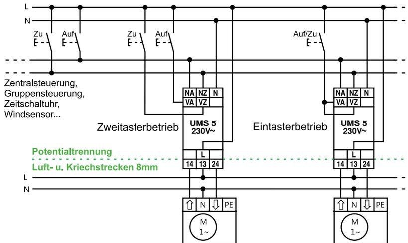
Beim Reiheneinbaugerät UMS 5 in der 230V Ausführung (UMS509) können die Versorgungsspannung, die Vororteingänge und die Nebenstelleneingänge mit jeweils anderen Phasen belegt werden.
