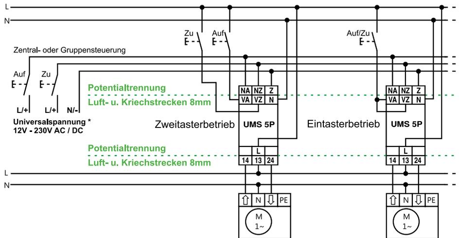
Bei der Gerätevariante UMS 5P sind die Nebenstelleneingänge galvanisch getrennt ausgeführt. Die Nebenstelleneingänge können somit auch aus anderen Spannungsnetzen heraus angesteuert werden.
