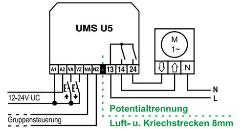
Die Gerätevarianten für 24V UC (UMS504) und für 12-24V UC (UMSU5V) werden mit 24V UC bzw. 12-24V UC versorgt und angesteuert. Über die potentialfreien Relaiskontakte können jedoch 230V Antriebe angesteuert werden.
