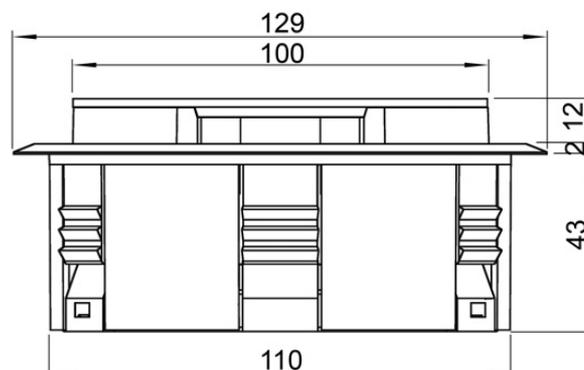
**Abbildung: Bodeneinheit 930.099 mit Teleskopdeckel 930.137**
