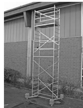
Базовая конструкция с первой и второй надстройками
