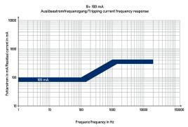
Diagramme Fehlerstromschutzschalter DFS 2 040-2/0,10-B+
