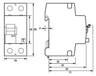
Maßzeichnung Fehlerstromschutzschalter DFS 2 040-2/0,10-B+
