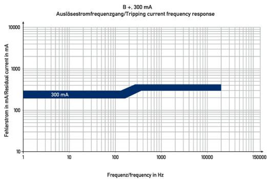
Diagramme Fehlerstromschutzschalter DFS 2 063-2/0,30-B+
