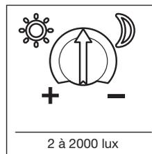
**Réglage de la luminosité de déclenchement ⑤**
