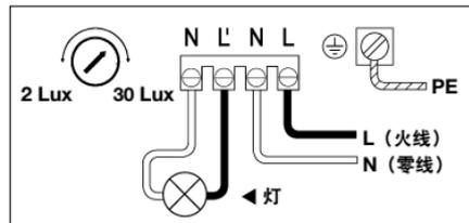
安装时注意尽可能从下方穿入导线。拧上外壳前，须刺破位于下方的冷凝水孔。
