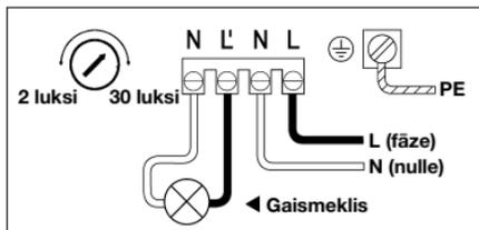
**Montāža** pie sienas. Uzmanību! Montāža nozīmē tīklā pieslēgumu. 230 V nozīmē draudus dzīvībai! Tādēļ vispirms jāatslēdz elektrība un ar sprieguma testerī jāpārbauda, vai sprieguma vairs nav. Krēslas slēdža instalēšana nozīmē darbu ar elektrotīkla spriegumu; tā jāizpilda profesionāli, saskaņā ar VDE 100.
