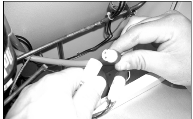
Fig. 67: Desencaixar os conectores do ventilador (3)
