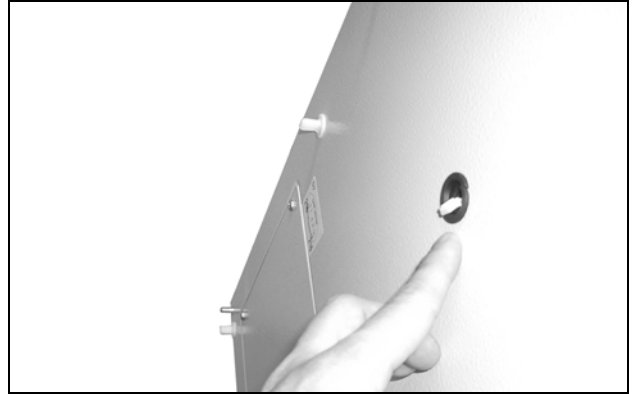
Fig. 46: Passar o cabo do display pela abertura
