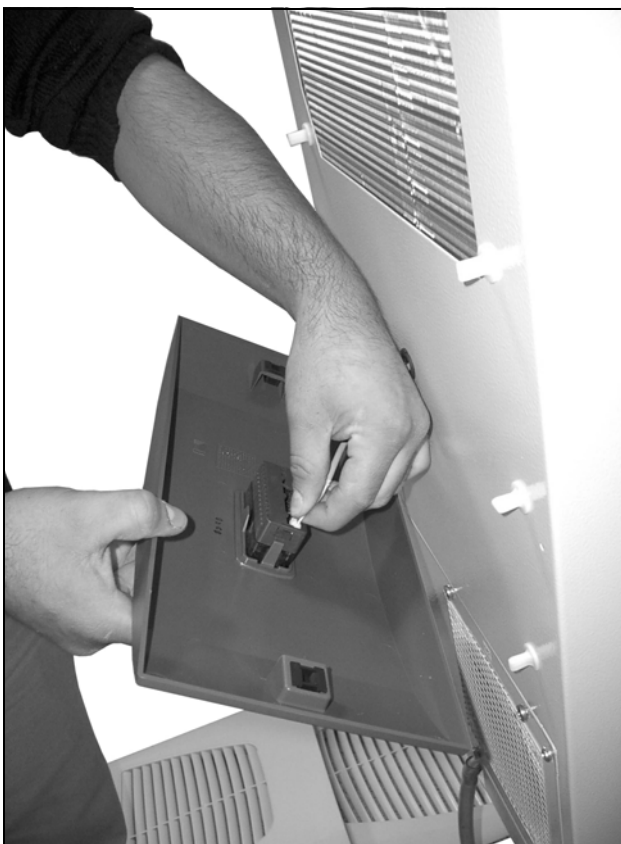
Fig. 38: Desencaixar o conector do display (1)
