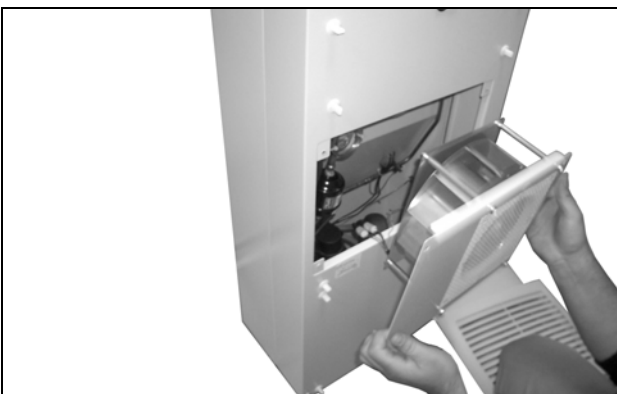
Fig. 64: Retirar o ventilador do circuito externo
