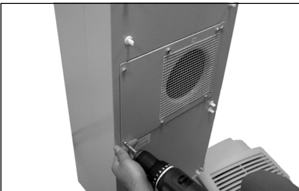
Fig. 63: Soltar os quatro parafusos do ventilador do circuito externo
