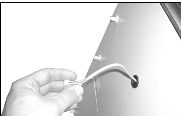
Fig. 45: Colocar o cabo do display para dentro
