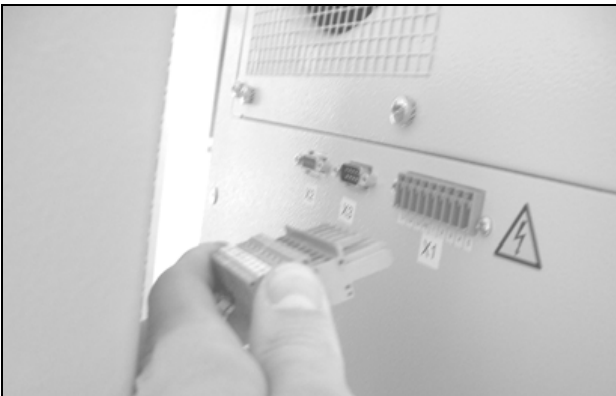
Fig. 34: Desconectar a alimentação de tensão
