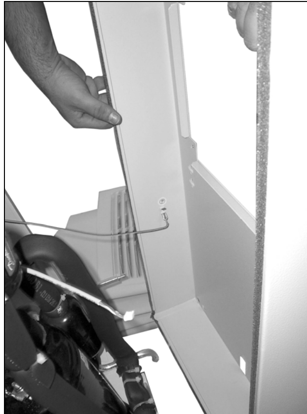
Fig. 72: Desencaixar o cabo de aterramento (1)
