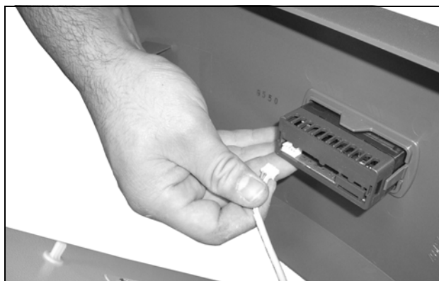
Fig. 60: Desconectar o cabo do display
