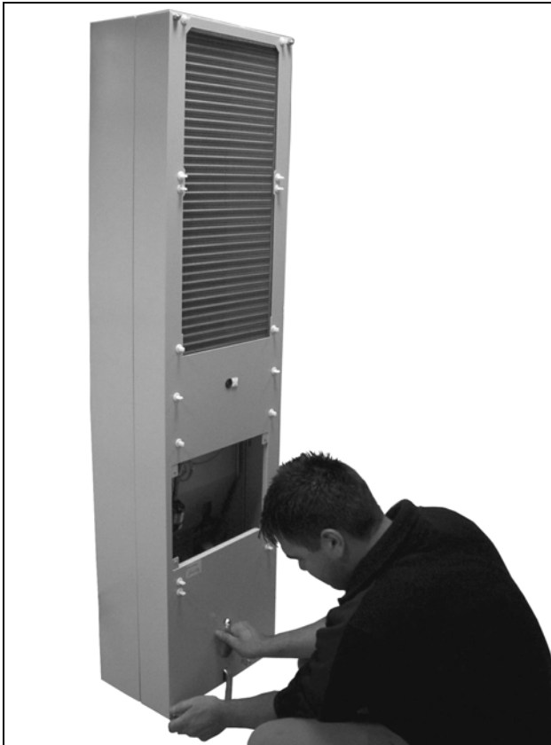
Fig. 70: Soltar as quatro porcas da tampa
