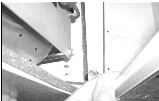
Fig. 50: Soltar o cabo de aterramento que se encontra entre a tampa e o chassi (2)
