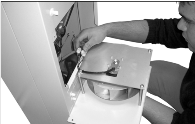
Afb. 65: Connectoren van de ventilator losnemen (1)
