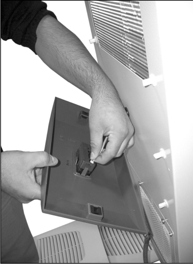
Rys. 38: Odłączanie wtyczki od wyświetlacza (1)
