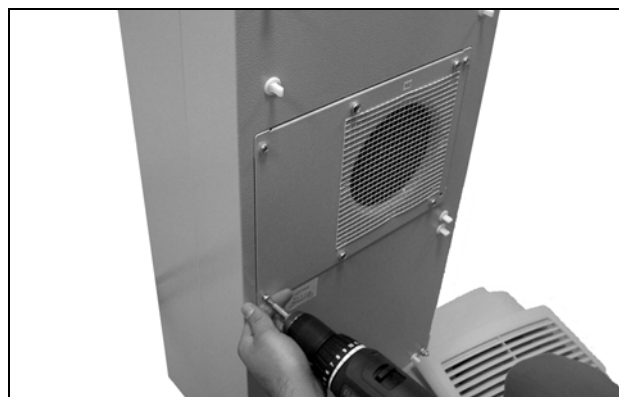
Rys. 63: Luzowanie czterech śrub wentylatora obiegu zewnętrznego
