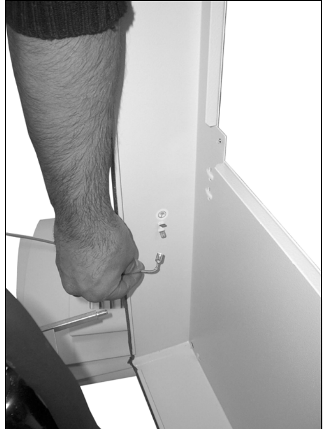
Rys. 73: Odłączanie kabla uziemiającego (2)
