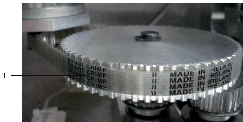
Fig. 9 : enlever la courroie crantée
