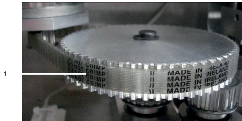
Fig. 9: Rimozione delle cinghie dentate
