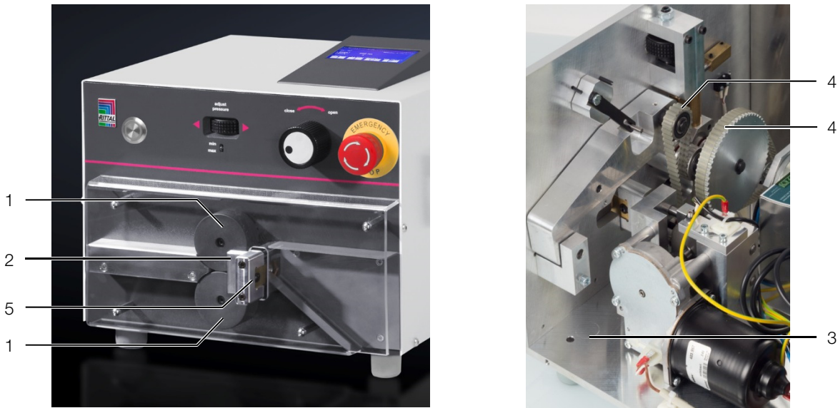
Afb. 8: Overzicht van de onderhoudspunten
