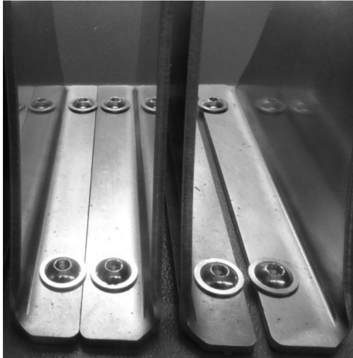
Abb. 5: Rollenhalter (Länge 8 mm: links, Länge 10 mm: rechts)
