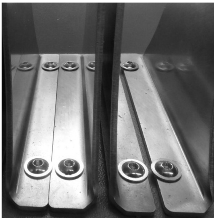
Afb. 5: Magazijnhouder (lengte 8 mm: links, lengte 10 mm: rechts)
