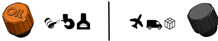
Fig. 3 : remplacement de la vis d'obturation par la vis de purge
