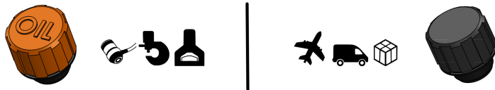
Abb. 3: Tausch der Verschlusschraube bzw. Belüftungsschraube (Darstellung beispielhaft)
