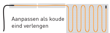
Aanpassing onmiddellijk na PTC-thermistor
