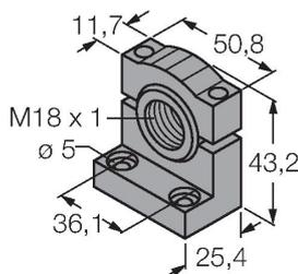
Montagehalterung, PBT-schwarz, für Sensoren mit 18-mm-Gewinde, ausrichtbar
