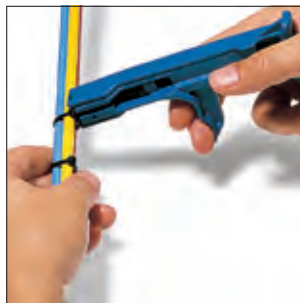
Werkzeug ansetzen, Kabelbinder spannen.
