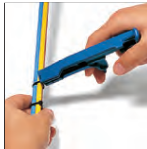
Abschneiden durch Drehen des Werkzeuges.
