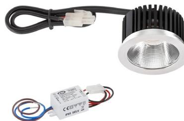
Der LED Einsatz kann als Ersatz zu herkömmlichen Halogen-, oder LED-Leuchtmitteln in zahlreiche Leuchten mit entsprechender Einbautiefe eingesetzt werden. Hierbei muss beachtet werden, dass der Kühlkörper durchgehend einen Durchmesser von 45mm hat. Die 15cm lange Anschlussleitung ist, für eine einfache Installation, mit einem AMP-Stecker versehen. Da im Lieferumfang das Netzgerät bereits enthalten ist, fallen auch hierfür keine zusätzlichen Kosten an.
