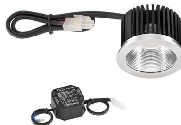
Der LED Einsatz kann als Ersatz zu herkömmlichen Halogen-, oder LED-Leuchtmitteln in zahlreiche Leuchten mit entsprechender Einbautiefe eingesetzt werden. Hierbei muss beachtet werden, dass der Kühlkörper durchgehend einen Durchmesser von 45mm hat. Die 15cm lange Anschlussleitung ist, für eine einfache Installation, mit einem AMP-Stecker versehen. Da im Lieferumfang das Netzgerät bereits enthalten ist, fallen auch hierfür keine zusätzlichen Kosten an.
