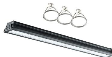
Hallenbeleuchtung mit extrem hoher Lichtausbeute für gewerbliche Anwendungen. Die Leuchte hat eine 23cm lange Anschlussleitung für den Hochvoltanschluss, sowie eine 23cm lange Anschlussleitung für die DALI-Schnittstelle. Im Lieferumfang sind drei, jeweils 1m lange, Seilabhängungen bereits enthalten. Das DALI-fähige Netzgerät ist in der Leuchte verbaut. Der Strahler verfügt über einen Überspannungsschutz von 4kV. Technische Daten: ta: -40°C - 55°C.
