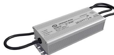
Der kurzschlussfeste Sicherheitstransformator lässt sich auf Grund der höheren Schutzart problemlos im Außenbereich einsetzen, kann aber z. B. auch beim Möbelbau verwendet werden, da die MM-Kennzeichnung gegeben ist. Die Anschlussleitungen haben eine Länge von 29cm primärseitig und 29cm sekundärseitig, ebenso hat auch die Anschlussleitung für die 1-10V-Schnittstelle eine Länge von 29cm. Technische Daten: Versorgungsspannung: 100-240V/AC, ta: -20°C - 50°C, tc: 75°C, Powerfaktor: 0,95.
