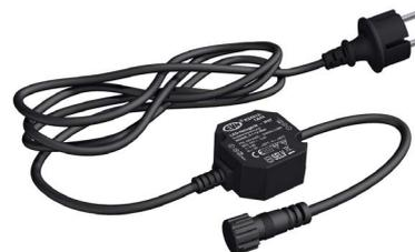
Der kurzschlussfeste Sicherheitstransformator kann auf Grund der höheren Schutzart problemlos im Außenbereich verwendet werden, lässt sich aber z. B. auch beim Möbelbau verwenden, da die MM-Kennzeichnung gegeben ist. Das Netzgerät verfügt primärseitig über eine 1,8m lange Gummileitung mit Konturenstecker und sekundärseitig über eine 20cm lange Gummileitung mit Buchse für das IP44-Stecksystem. Technische Daten: Versorgungsspannung: 220-240V/AC, ta: -20°C - 50°C, tc: 80°C, Powerfaktor 0,95.
