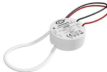
Der kurzschlussfeste Sicherheitstransformator lässt sich auf Grund der kleinen Bauform perfekt in Schalterdosen verbauen, kann aber auch beim Möbelbau zum Einsatz gebracht werden, da die MM-Kennzeichnung gegeben ist. Die Anschlussleitungen haben eine Länge von 14cm primärseitig und 17cm sekundärseitig. Technische Daten: Versorgungsspannung: 100-240V/AC, ta: -20°C - 50°C, tc: 80°C, Powerfaktor: 0,90.
