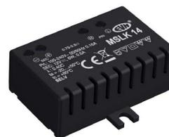
Das LED-Netzgerät lässt sich auf Grund der kleinen Bauform perfekt in Schalterdosen verbauen, kann aber auch beim Möbelbau zum Einsatz gebracht werden, da die MM-Kennzeichnung gegeben ist. Der Anschluss primärseitig und sekundärseitig erfolgt durch Schraubklemmen, welche für Kabel von 0,75mm<sup>2</sup> - 2,5mm<sup>2</sup> geeignet sind. Technische Daten: Versorgungsspannung: 100-240V/AC, ta: -20°C - 50°C, tc: 80°C, Powerfaktor: 0,40.
