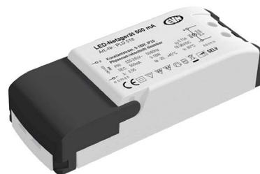
Der kurzschlussfeste Sicherheitstransformator kann problemlos beim Möbelbau zum Einsatz gebracht werden, da die MM-Kennzeichnung gegeben ist. Der Anschluss primärseitig und sekundärseitig erfolgt durch Schraubklemmen, welche für Kabel von 0,75 - 2,5mm<sup>2</sup> primärseitig bzw. 0,5mm<sup>2</sup> - 2,5mm<sup>2</sup> sekundärseitig geeignet sind. Technische Daten: Versorgungsspannung: 220-240V/AC, ta: -20°C - 45°C, tc: 80°C, Powerfaktor 0,95.
