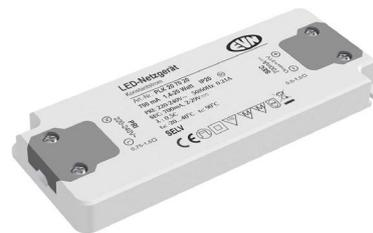
Der kurschlussfeste Sicherheitstransformator lässt sich auf Grund der flachen Bauform auch in beengten Platzverhältnissen montieren, kann aber auch problemlos beim Möbelbau zum Einsatz gebracht werden, da die MM-Kennzeichnung gegeben ist. Der Anschluss primärseitig und sekundärseitig erfolgt durch Schraubklemmen, welche für Kabel von 0,75mm<sup>2</sup> - 1,5mm<sup>2</sup> geeignet sind. Technische Daten: Versorgungsspannung: 220-240V/AC, ta: -20°C - 40°C, tc: 90°C, Powerfaktor 0,50.
